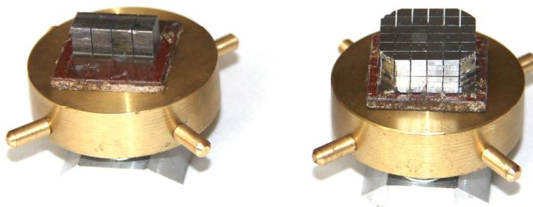
Рис. 7. Резка термоэлектрического материала связанным абразивом.
