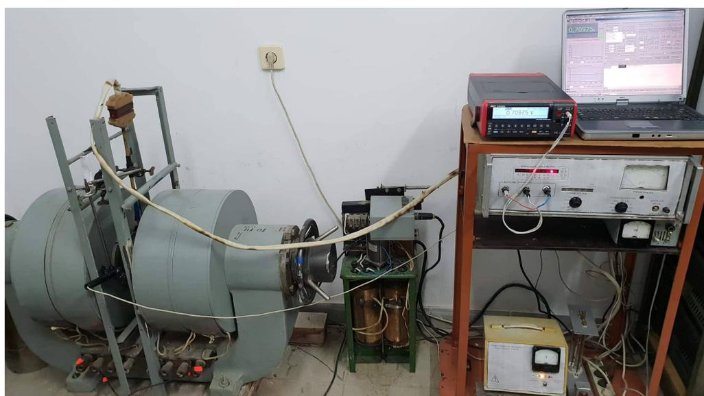
Рис. 5. Общий вид установки автоматизированных измерений термоэлектрических параметров полупроводников.
