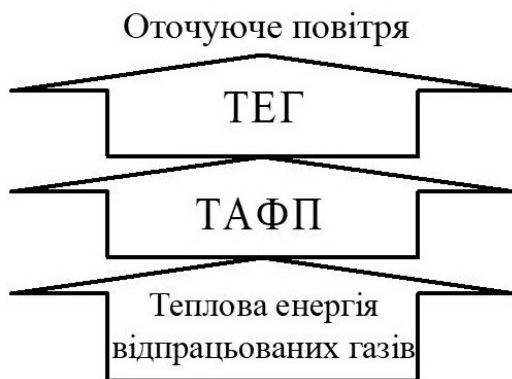
Рис. 1. Схема потоків теплової енергії в запропонованій термоелектричній системі утилізації теплової енергії ВГ з тепловим акумулятором фазового переходу.
