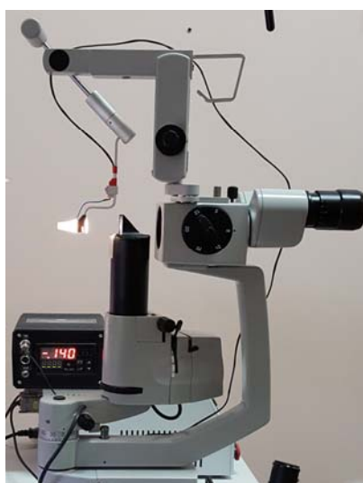
Рис. 1. Термоелектричний прилад для визначення теплового потоку з поверхні очей: 1 – термоелектричний сенсор теплового потоку, 2 – термоелектричний термопарний датчик температури, 3 – електронний блок керування
