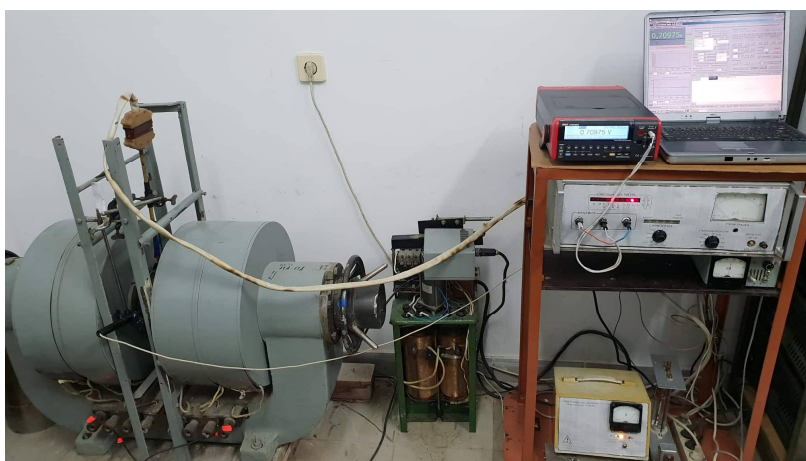
Рис. 5. Загальний вигляд установки автоматизованих вимірювань термоелектричних параметрів напівпровідників.
