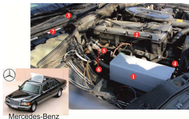
Рис.2. Термоелектричний передпусковий нагрівник на автомобілі «Mercedes»: 1 – термоелектричний передпусковий нагрівник; 2 – двигун; 3 – верхня панель радіатора системи опалення; 4 – штатний рідинний насос автомобіля; 5 – циркуляційна рідинна помпа нагрівника; 6 – комутаційні шланги; 7 – акумуляторна батарея.
