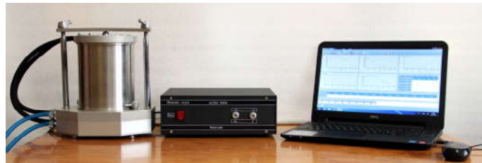
Рис. 17. Зовнішній вигляд автоматизованої установки для визначення властивостей термоелектричного матеріалу в інтервалі температур 30-900 0 С.
