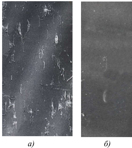
Рис. 3. Топограми тонких пластинчатих зразків CdSb. Відбивання (004), а- край зразка, б – центр зразка. \times 12 .
