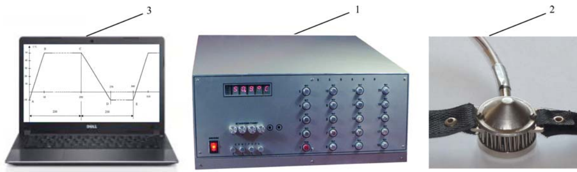
Рис. 1. Термоелектричний прилад для рефлексотерапії «АЛТЕК–7009»: 1 – блок живлення та керування приладу, 2 – термоелектричний зонд, 3 – персональний комп'ютер (ПК).
