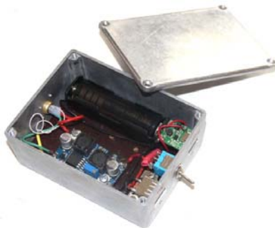
Рис. 12. Блок стабілізації вихідної напруги генераторного блоку: а). електрична схема; б). зовнішній вигляд: X3.1-X3.2 – з'єднувальний кабель; X4.1 – вхідне гніздо стабілізатора; X5.1 – вихідне гніздо стабілізатора; SW1 – перемикач; E1 – літій-іонний акумулятор; A3 – контролер заряду; A2 – понижуючо-підвищуючий DC/DC перетворювач.
