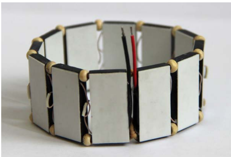
Рис. 11. Зовнішній вигляд термоелектричного браслета.
