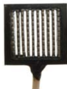
Рис. 3. Зовнішній вигляд термоелектричного давача температури та теплового потоку.
