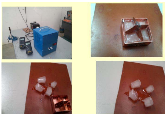
Рис. 8. Спільний проект Міністерства Промисловості (KOSGEB) і фірми TES Ltd. «Настільний термоелектричний льодогенератор».
