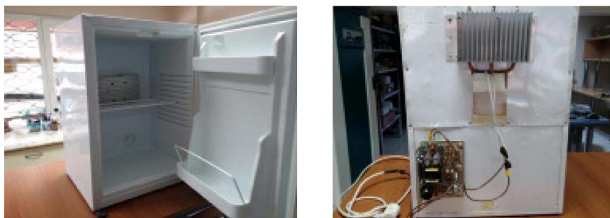
Рис. 7. Спільний проект ТУВИТАК і фірми TES Ltd. «Термоелектричний мінібар з тепловою трубою».
