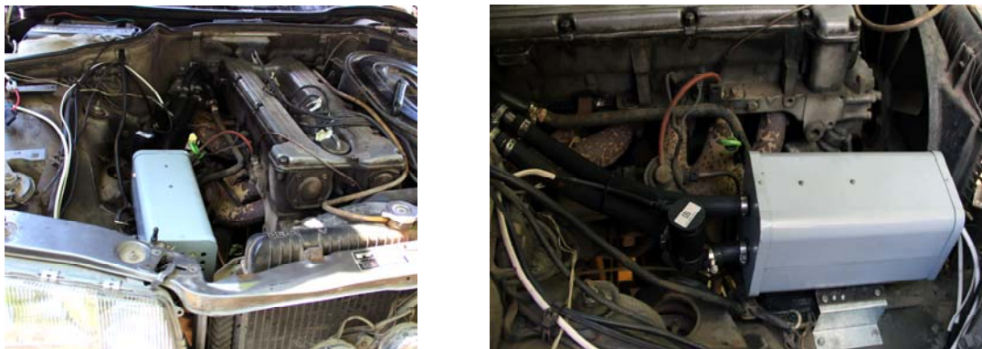
Рис. 8. Термоелектричний передпусковий нагрівник на автомобілі «Mercedes».
