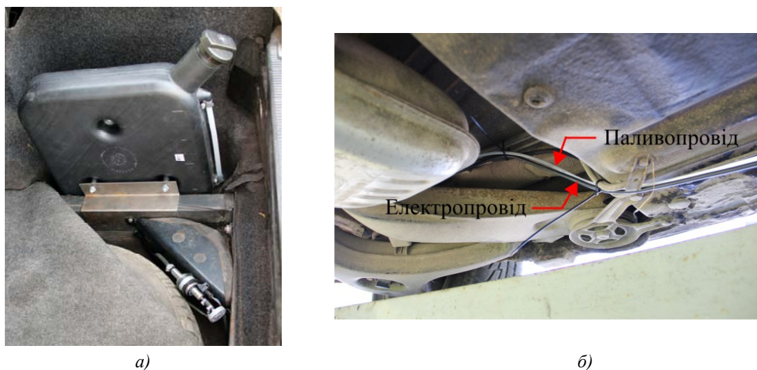
Рис. 9. Розміщення паливної ємності та паливного насосу (а), електро- та паливо проводів (б).
