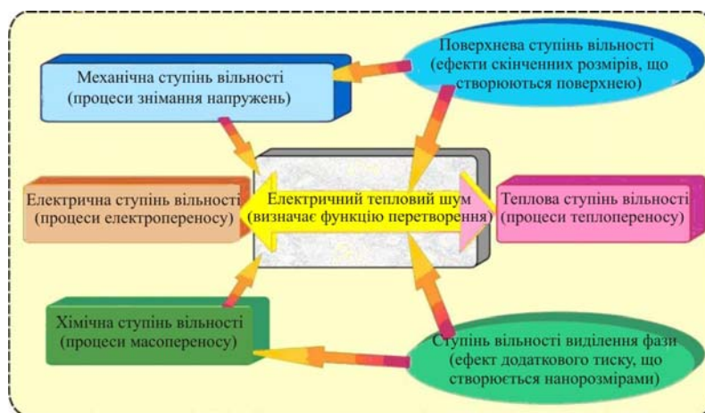
Рис. 4. Формування шумів різних типів і функцій перетворення (нано)термометрів у зв'язку з відповідними ступенями вільності основного рівняння нанотермодинаміки.
