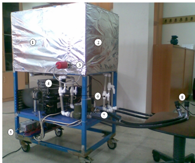
Рис. 3. Система рециркуляції гарячої й холодної води.
