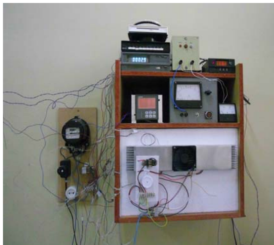
Рис. 1. Транспортний термоелектричний холодильник (вигляд з боку термоелектричного агрегату) під час випробувань.
