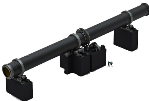
Рис. 1. Зовнішній вигляд цементної печі [10].
