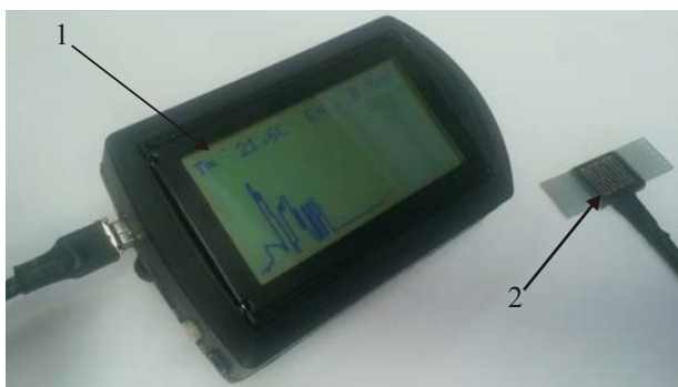
Рис.1. Електронний регістратор з обробкою сигналів термоелектричного сенсора теплового потоку: 1 - електронний регістратор, 2 – термоелектричний сенсор
